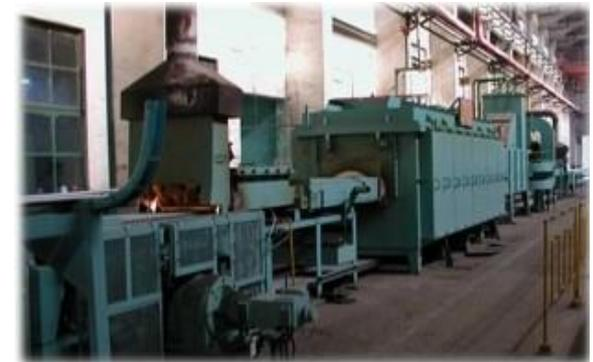
Сетчатая лента Специальная линия термообработки труб из нержавеющей стали для всех стальных труб с защитой от водорода
