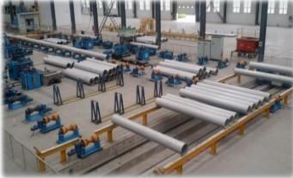
Конвейерная линия из сварных труб из нержавеющей стали
