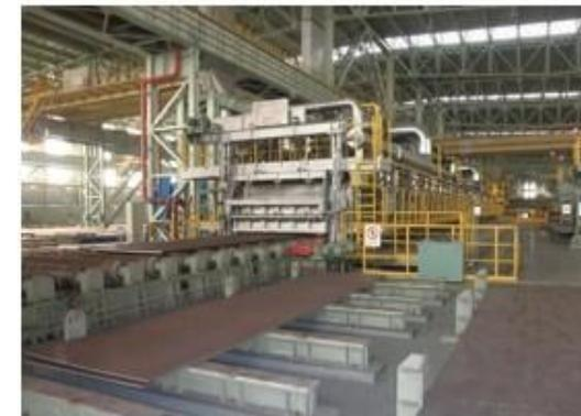
Производственная линия термообработки с роликовым дном
