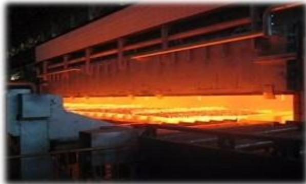
Термическая обработка растворов стальной трубы 18 м Камерная печь и поддерживающая загрузочно-разгрузочная машина
