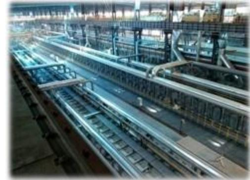
Линия для термообработки высокопрочного листа
