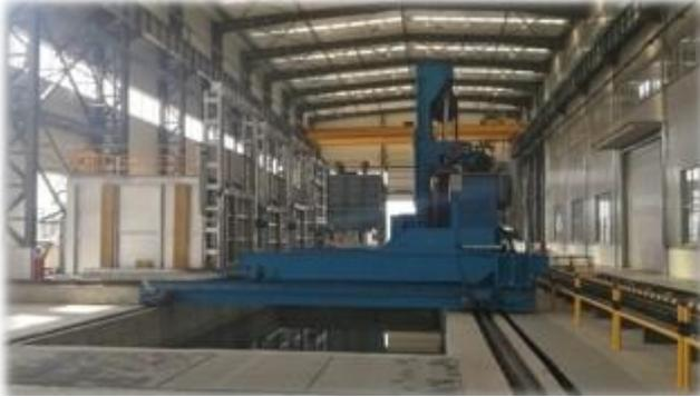
Группа печей сопротивления для термообработки, машина для загрузки стали и система закалки
