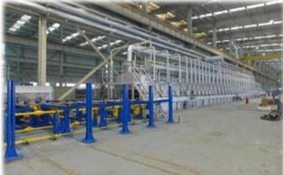
Термическая обработка линии производства труб
