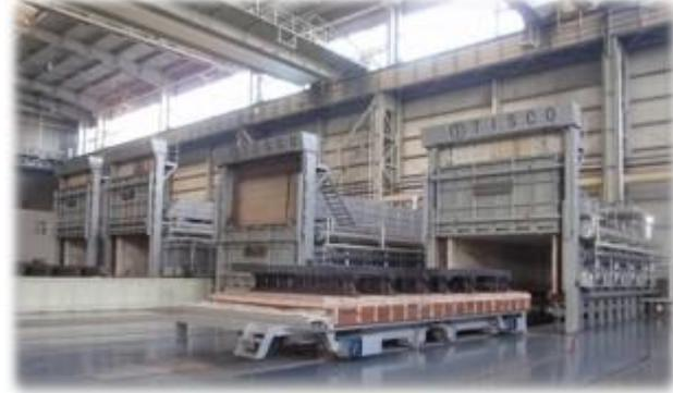
Группа печей для термообработки типа тележки
